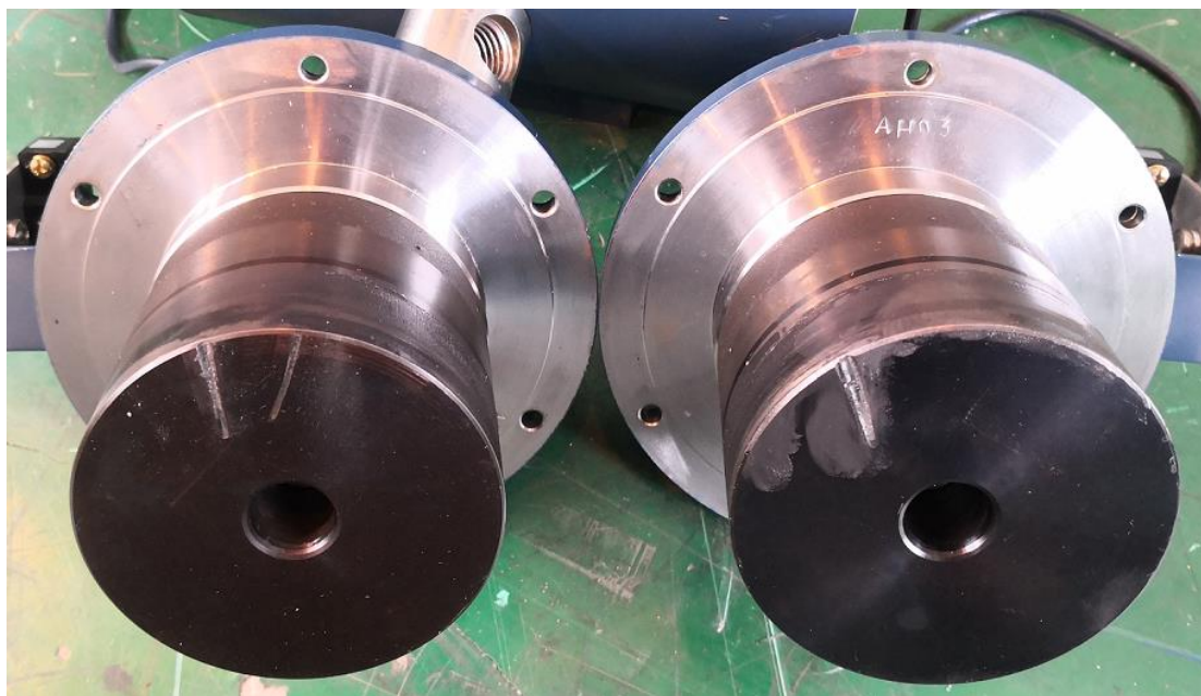
600 次手动松闸试验后的铁芯端面
