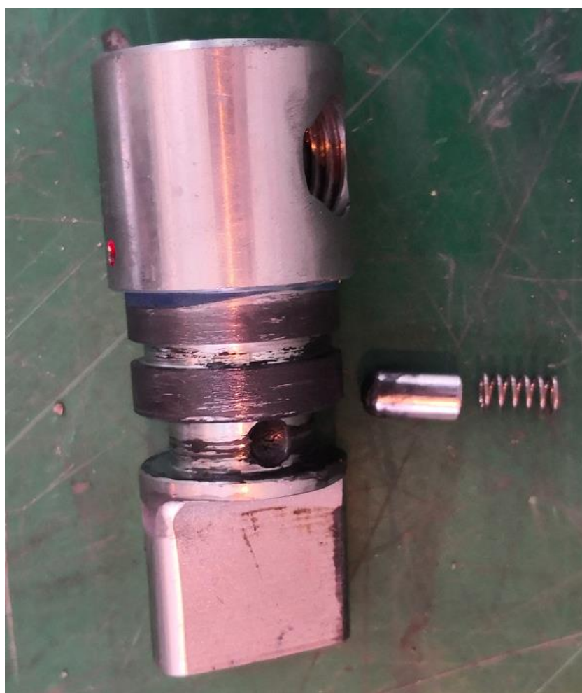
松闸顶杆及定位装置（一个弹簧）
